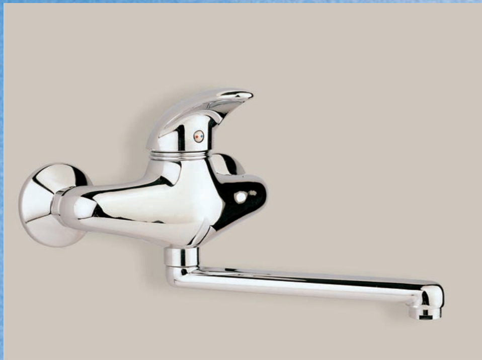
Art. 1033 MISCELATORE MONOCOMANDO LAVELLO A PARETE Bocca di erogazione girevole mm. 200 o 300, eccentrici da 1/2" regolabili per interasse da mm.150 +- 15 WALL MOUNTED SINGLE LEVER SINK MIXER Swivel spout mm. 200 or 300, s-tailpieces with 1/2" connections, centre distance mm 150 +-15
